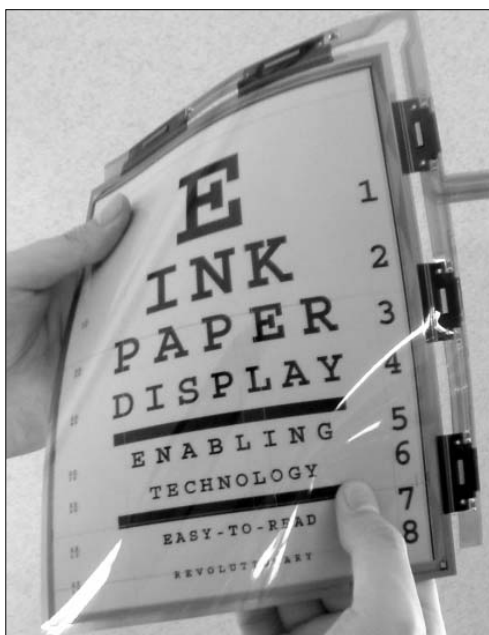
Un primo prototipo di schermo flessibile per computer prodotto dalla E-Ink Corporation con sede a Cambridge, nello stato americano del Massachusetts A fianco: Piante di papiro (particolare)
